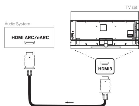
Usa un cavo HDMI (non fornito) per connettere una presa HDMI eARC del televisore alla presa HDMI ARC/eARC di un sistema audio o una soundbar. Si consiglia di usare un cavo denominato "Cavo HDMI a velocità ultra alta" con un connettore di Tipo A.
