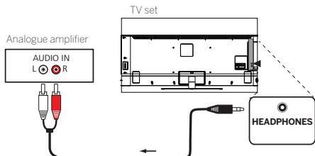
Utilisez un câble adaptateur stéréo pour connecter la sortie audio HEADPHONES à l'entrée audio analogique du système audio.
