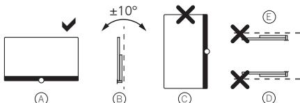
Stellen Sie das Fernsehgerät an einem Ort auf, an dem es keiner direkten Sonneneinstrahlung und keiner zusätzlichen Erwärmung durch Heizkörper ausgesetzt ist!
