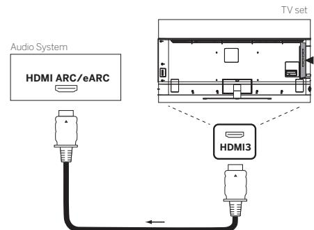
Benutzen Sie ein HDMI-Kabel (nicht im Lieferumfang enthalten), um die HDMI-eARC-Buchse des Fernsehgeräts mit der HDMI-ARC/eARC-Buchse eines Audiosystems oder einer Soundbar zu verbinden. Wir empfehlen, dass Sie ein als „Ultra-High-Speed-HDMI-Kabel“ gekennzeichnetes Kabel mit einem Typ-A-Stecker verwenden.
