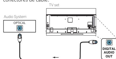
Conecte la salida de audio del televisor etiquetada como DIGITAL AUDIO OUT a la entrada de audio del sistema de audio.
