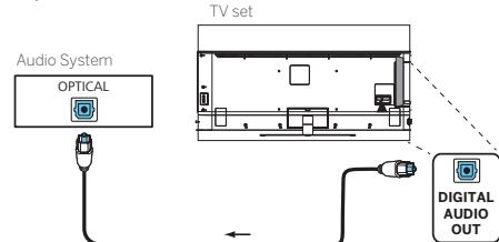
Connectez la sortie audio du téléviseur étiquetée DIGITAL AUDIO OUT à l'entrée audio numérique d'un système audio.
