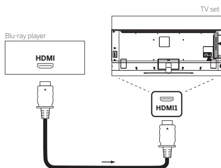
Verbinden Sie das Gerät über ein HDMI-Kabel mit einem Typ-A-Anschluss (nicht im Lieferumfang enthalten) mit einem der HDMI-Anschlüsse des Fernsehgeräts. Um die Funktionen Ihres Fernsehers voll auszuschöpfen, benutzen Sie ein Kabel mit der Kennzeichnung „Premium High-Speed HDMI-Kabel“ oder besser.
