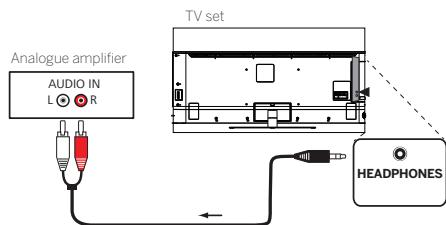
Verbinden Sie den Audioausgang „HEADPHONES“ über ein Stereo-Cinch/Klinken-Adapterkabel mit dem analogen Audioeingang der Audioanlage.
