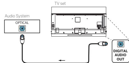
Sluit de audio-uitgang van de tv met het label DIGITAL AUDIO OUT aan op de digitale audio-ingang van een audiosysteem.
