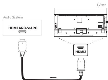
Utilisez un câble HDMI (non fourni) pour connecter la prise HDMI eARC du téléviseur à la prise HDMI ARC/eARC d'un système audio ou d'une barre de son. Il est recommandé d'utiliser un câble marqué « Câble HDMI Ultra High-Speed » avec un connecteur de type A.
