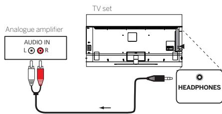
Gebruik een stereo cinch-connector/adapterkabel om de audio-uitgang HEADPHONES aan te sluiten op de analoge audio-ingang van het audiosysteem.
