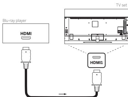
Sluit het apparaat via een HDMI-kabel met een type A-connector (niet meegeleverd) aan op één van de HDMI-aansluitingen van het TV-toestel. Om de mogelijkheden van uw tv optimaal te benutten, gebruikt u een kabel met het label "Premium High-Speed HDMI Cable" of beter.
