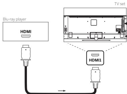
Conecte el dispositivo con un cable HDMI con conector de tipo A (no suministrado) a una de las tomas HDMI del televisor. Para disfrutar de las funciones de su televisor, utilice un cable de tipo Premium High-Speed HDMI o superior.
