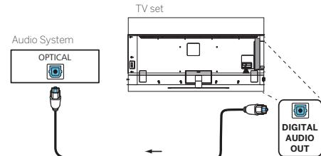
Verbinden Sie den Audioausgang des Fernsehgeräts mit der Bezeichnung „DIGITAL AUDIO OUT“ mit dem digitalen Audioeingang eines Audiosystems.
