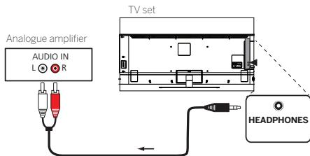
Utilice un adaptador/conector estéreo para conectar la salida de audio HEADPHONES a la entrada de audio analógica del sistema de audio.
