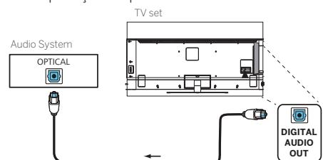
Ligue a saída de áudio do televisor marcada como DIGITAL AUDIO OUT à saída de áudio digital do sistema de um sistema de áudio.
