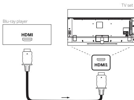
Ligue o dispositivo através de um cabo HDMI com um conector de tipo A (não fornecido) a uma das tomadas HDMI do televisor. Para desfrutar totalmente das capacidades do seu televisor, use um cabo com a etiqueta "Cabo HDMI de alta velocidade premium" ou melhor.
