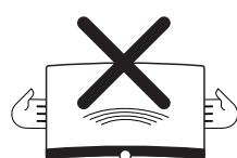
Geräterahmen nicht zu groß ist. Sonst kann es vor allem bei großformatigen Displays zu einer Beschädigung des Displays kommen.
