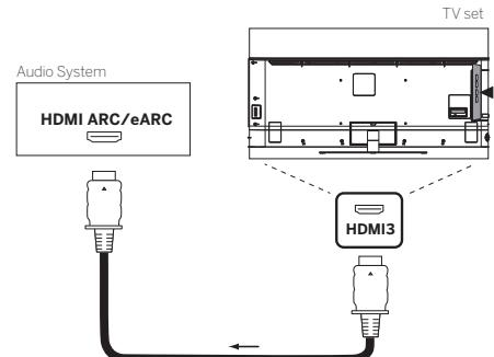
Gebruik een HDMI-kabel (niet meegeleverd) om de HDMI eARC-aansluiting van de tv te verbinden met de HDMI ARC/eARC-aansluiting van een audiosysteem of soundbar. We raden aan om een kabel te gebruiken met de aanduiding "Ultra High-Speed HDMI Cable" en een type A connector.
