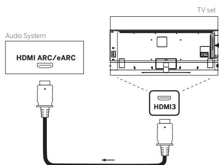
Use un cable HDMI (no suministrado) para conectar la toma HDMI eARC del televisor a la toma HDMI ARC/eARC de un sistema de audio o barra de sonido. Se recomienda utilizar el cable marcado como "Ultra High-Speed HDMI Cable" con un conector de tipo A. Los cables Ultra High Speed HDMI están diseñados para permitir la nueva función eARC, además de los modos más altos de resolución. Los cables HDMI estándar con Ethernet y los cables HDMI de alta velocidad con Ethernet también admiten eARC.
