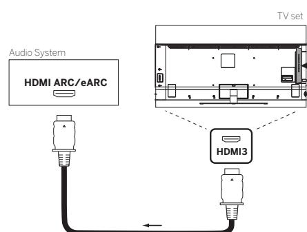
Use um cabo HDMI (não fornecido) para ligar a tomada HDMI eARC do televisor à tomada HDMI ARC/eARC de um sistema de áudio ou da barra de som. Recomenda-se a utilização de um cabo marcado como "Cabo HDMI ultra de alta velocidade" com um conector de tipo A.
