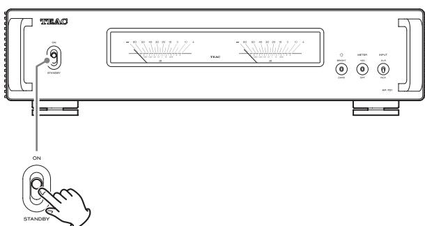
Le voyant d'état s'allume et la fonction de coupure du son est activée. Quand l'amplificateur s'est stabilisé, le voyant s'éteint et la fonction de coupure du son est désactivée.
